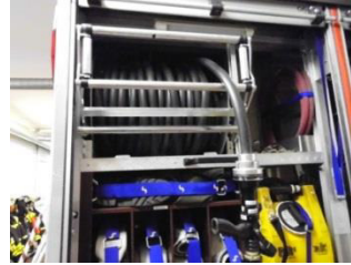
Abb. 22 Schnellangriffseinrichtung Feuerwehr Castrop-Rauxel
