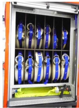
Abb. 23 Einrichtung zur schnellen Wasserabgabe Fw Castrop-Rauxel
