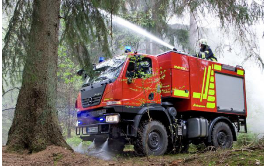
Abb. 29 TLF 2000 Fa. Schlingmann mit Selbstschutzanlage
